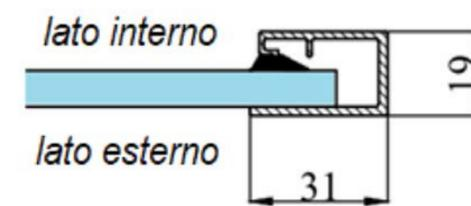
VASCA VS SEZIONE PROFILO A MURO
