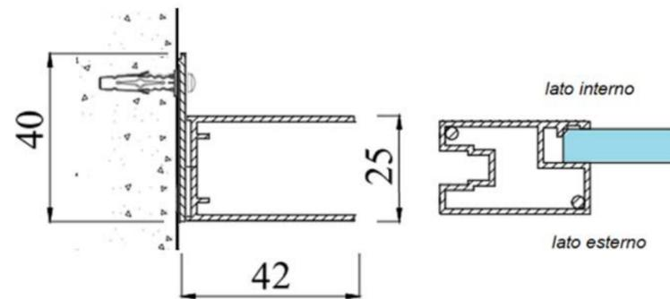
SEZIONE PROFILO A MURO PER ANGOLO
