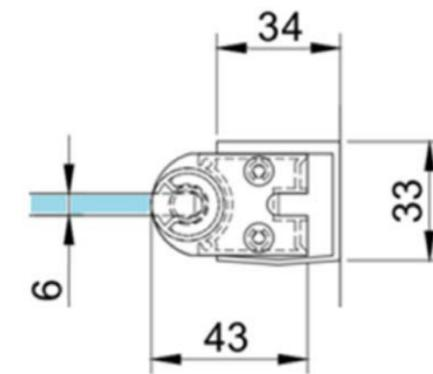
VASCA VD SEZIONE PROFILO A MURO
