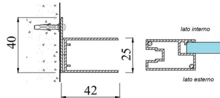
SEZIONE PROFILO A MURO PER ANGOLO
